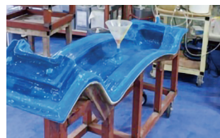
シリコン型を併用した真空成形法による試作
