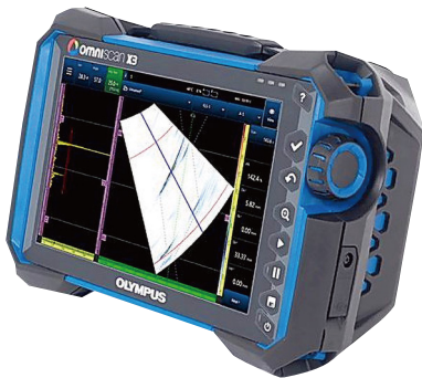
フェーズドアレイ超音波探傷器(PA-UT)
