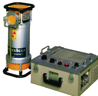
エックス線発生装置+モバイル型イメージングスキャナ(D-RT)
