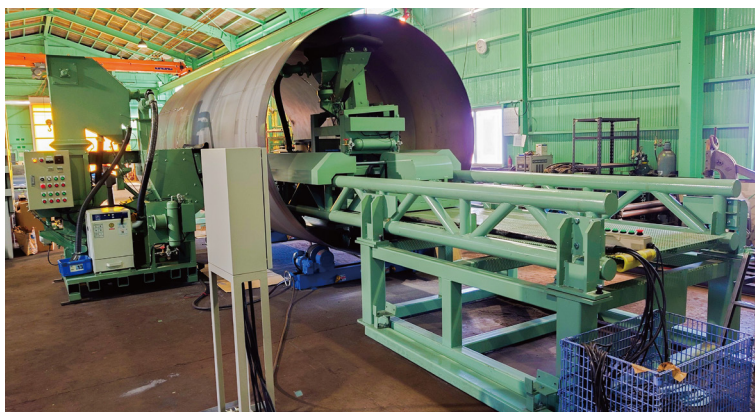
ウインドタワー内外面防錆塗装処理前用 無人高速ブラストマシンの開発
