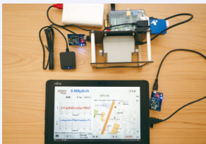
UAV搭載型空間線量計
